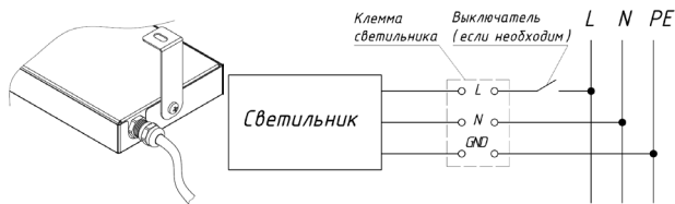
Рисунок 5. Схема подключения светильника.
